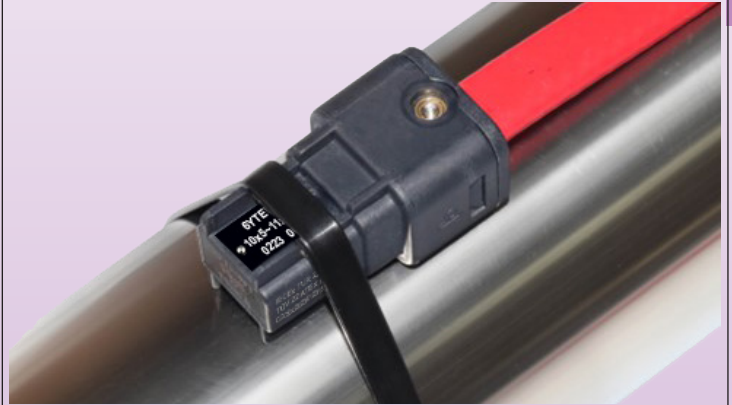
电缆插入拧紧并安装在管道上
